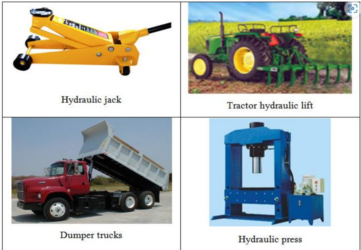
Figure 1.4.2 तेल हायड्रॉलिक प्रणालींचे अनुप्रयोग (Ref: http://ecoursesonline.iasri.res.in/ )
