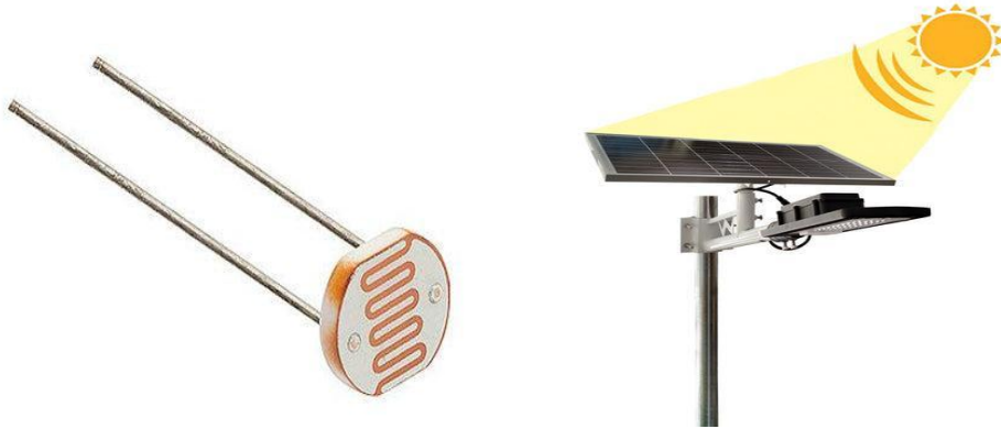
Figure. 4.2.5.1 – स्ट्रीट लाइट्सच्या ऑटोमॅटिक ऑन-ऑफसाठी एल.डी.आर. (LDR for automatic On-Off of Street Lights)
