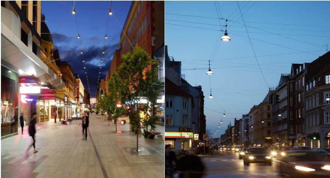
Figure. 4.1.5.5 – सस्पेंडेड अरेंजमेंट (Suspended arrangement)
