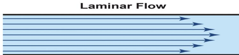
Fig. 3.5. लॅमिनार प्रवाह (स्रोत- ( https://tinyurl.com/2s94t5pp )
