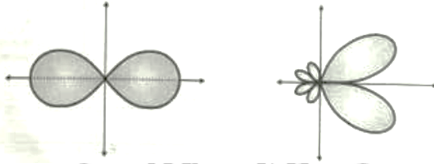
(a) \lambda/2 डायपोल रेझोनंट अँटेना (b) नॉन रेझोनंट अँटेना आकृती क्र. 5.1: रेझोनंट पॅटर्न
