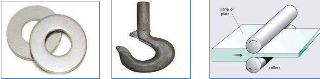
(a) वॉशर (b) क्रेन हुक (c) पातळ(कमी जाडीचे) पत्रे आकृती 4.0.3 फॉर्मिंग प्रक्रियेचे उत्पादने उदाहरणे
